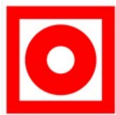
4. att. Vecā parauga zīme – Uguns aizsardzības sistēmas manuālā iedarbināšanas ierīce
