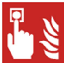
5. att. Jaunā parauga zīme – Uguns aizsardzības sistēmas manuālā iedarbināšanas ierīce
