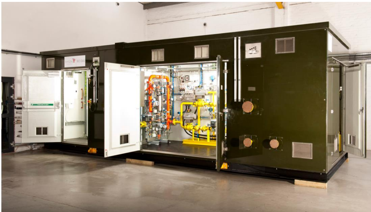
1. att. Potenciālais reģionālais biometāna ievades punkts
